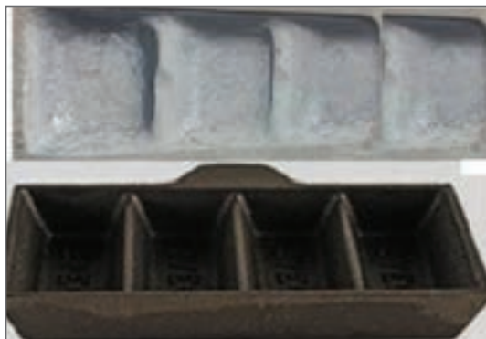
شکل ۵- قالب ریژه شمش ریزی
