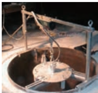
شکل ۲۲- ویبراتور دیوار کوب اتوماتیک
