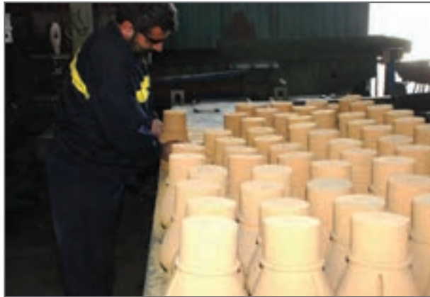
شکل ۱۸- کنترل ماهیچه‌ها هنگام انبارش
