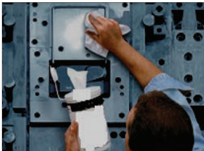
شکل ۱۱- تمیزکاری قالب‌های فلزی
