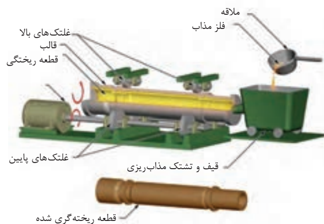
شکل ۹- ریخته گری گریز از مرکز
