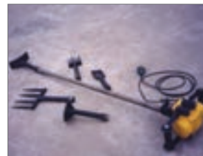
شکل ۱۲- کوبه ماشینی با سرهای قابل تعویض
