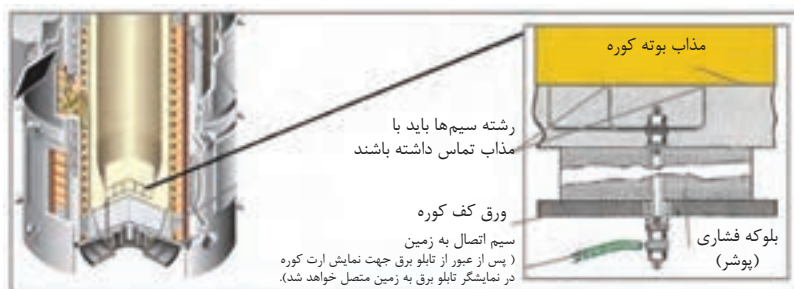
شکل ۱۰- شماتیک اتصال سیم ارت در کوره القایی
